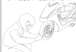
④ 타이어 균열, 손상, 이상마모, 금속파편, 돌등의 이물질 및 홈의 깊이
